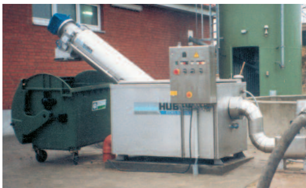
Обогреваемая, имеющая теплоизоляцию установка ROTAMAT® Ro 3.1 в комбинации с барабанной решеткой ROTAMAT®
