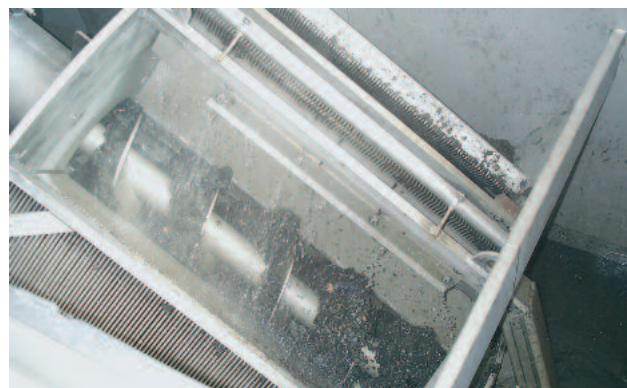
Всплывающие и взвешенные вещества, задерживаемые фильтрующим барабаном. Зубцы входят в прозоры барабана и обеспечивают полную автоматическую очистку.
