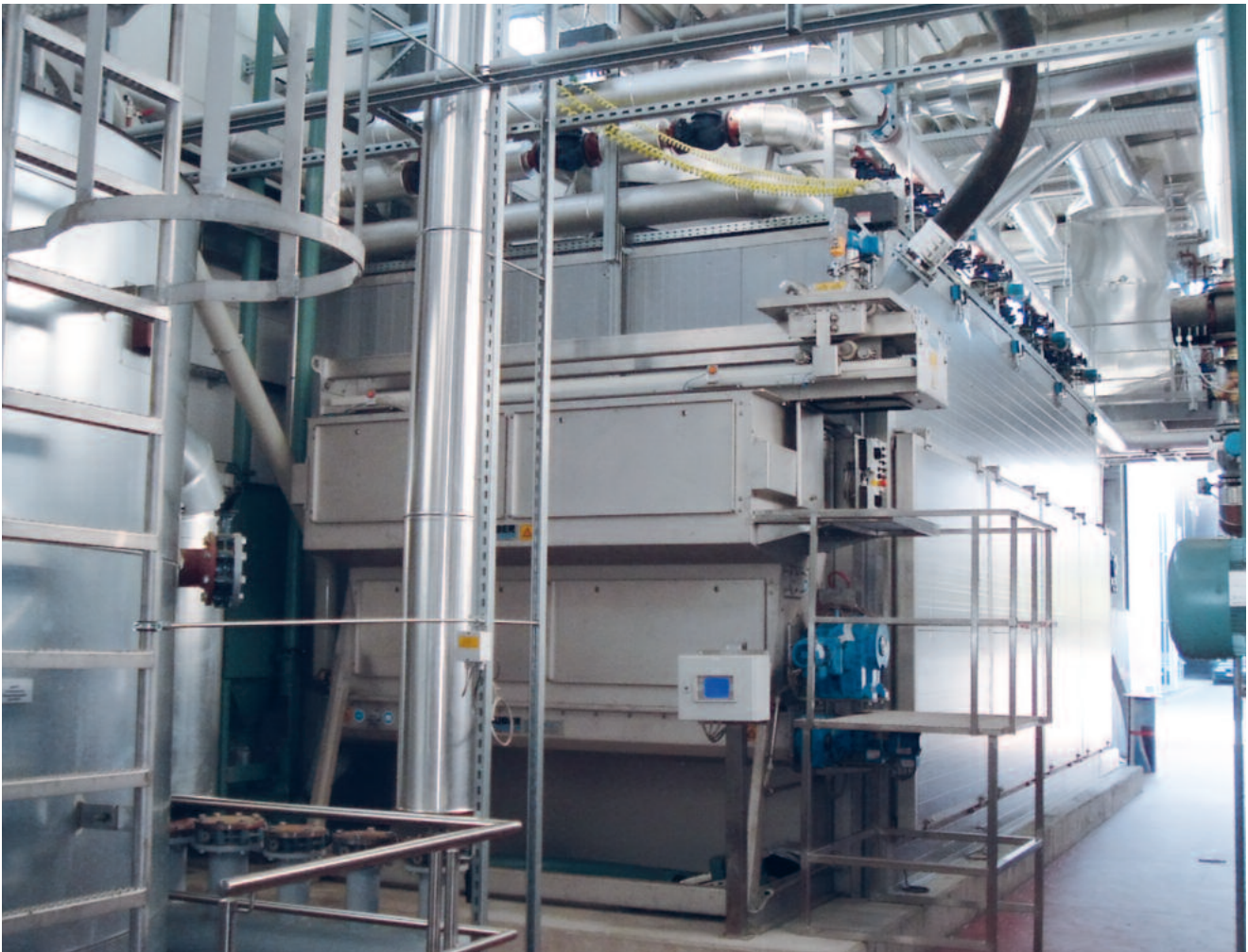
Ленточная сушка HUBER BT с подачей сырого осадка пеллетировщиком и выгрузкой высушенного продукта поперечным шнеком
