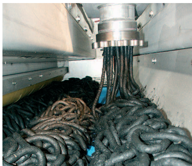
Выкладка осадка на ленту через экструдер является ключевым фактором эффективности установки
