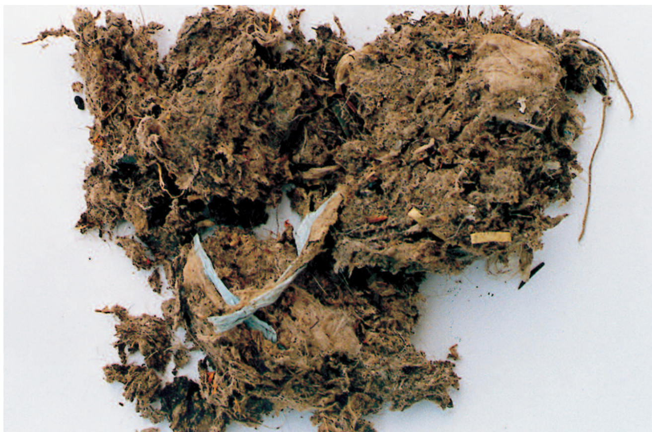
Residuo tamizado: pelos, fibras de papel, de madera, plásticos, chapa, goma, fibras textiles, etc.
