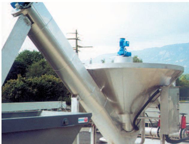
高新技术: COANDA 洗砂装置 规格: RoSF 4 / BG III, 室外安装, 配置加热部件
