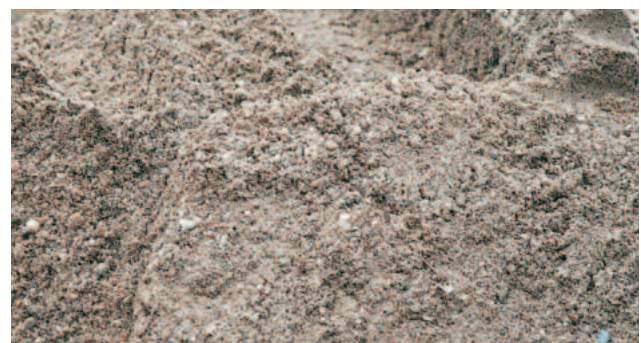
污水厂的砂清洗后
