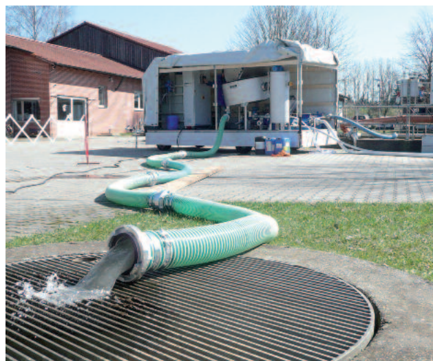
移动型转盘浓缩机 RoS 2S；前面流出的是过滤液
