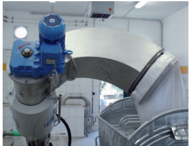
根据项目情况量身制作，例如：侧边型排渣槽直接将栅渣排入集装箱
