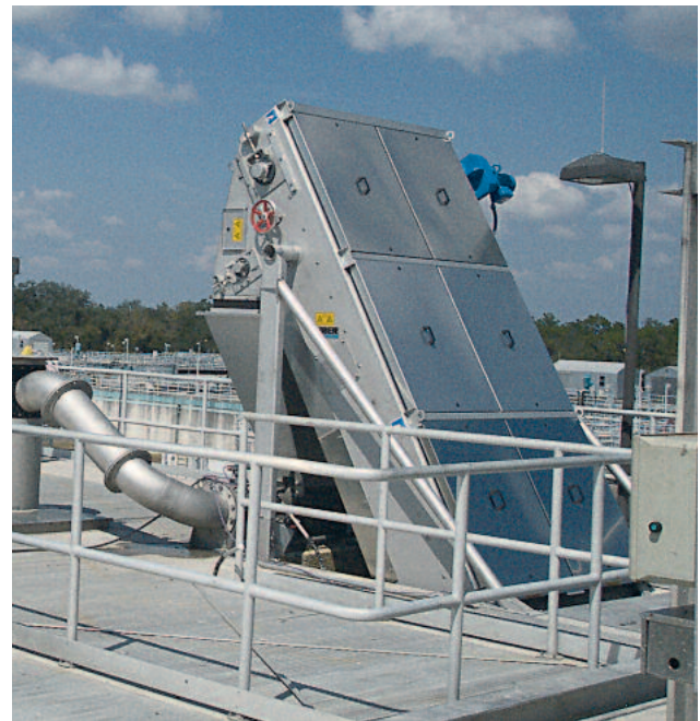
无臭气, 全封闭式EscaMax®, 无臭气, 盖板可打开
