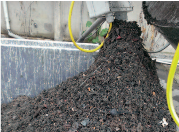
Austrag aus HUBER Siebanlage ROTAMAT® Ro2: Feststoffe aus der Lederproduktion
