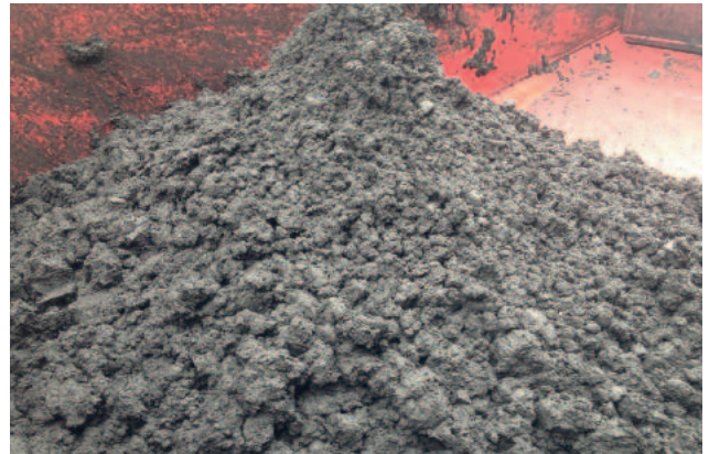
Austrag aus HUBER Schneckenpresse S-PRESS: Entwässerter Mischschlamm
