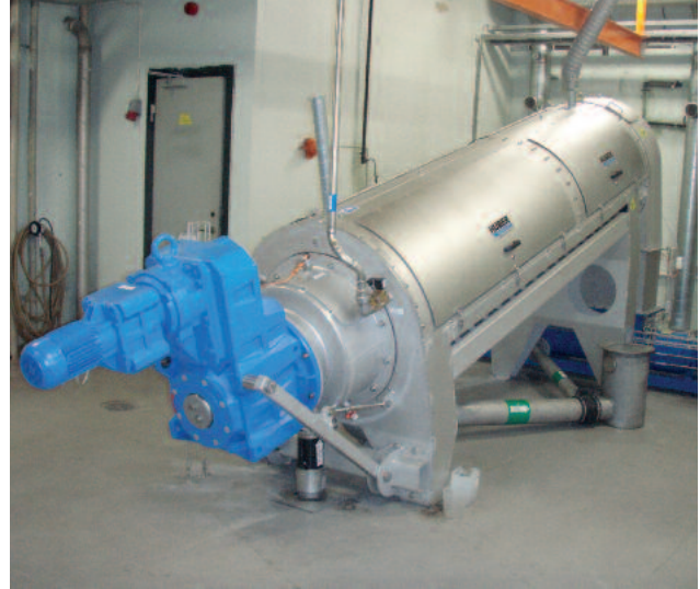
Schlammwässerung Textilindustrie Brasilien: HUBER Schneckenpresse Q-PRESS®
