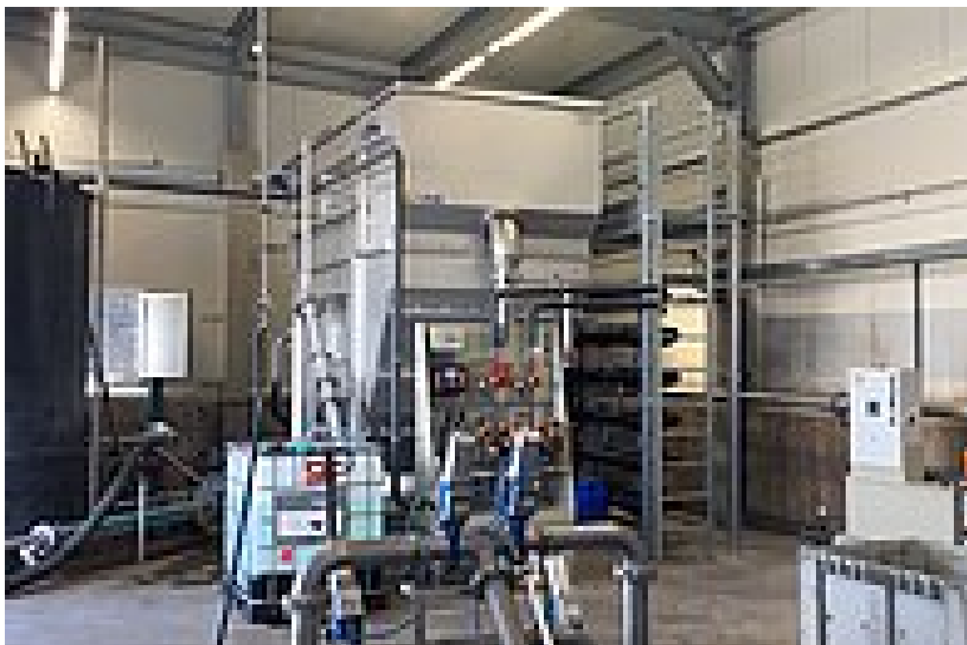
Flotación por aire disuelto HUBER HDF10 con etapa química
